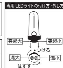
専用LEDライトの突起大とシェード側の溝大を、突起小と溝小とを合わせてはめ込んだ後、ライトを右に回して取付けてください。
