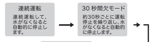
※1回のご使用ごとに最低30分以上は休止してください。超音波振動板が過熱して、故障の原因となります。
